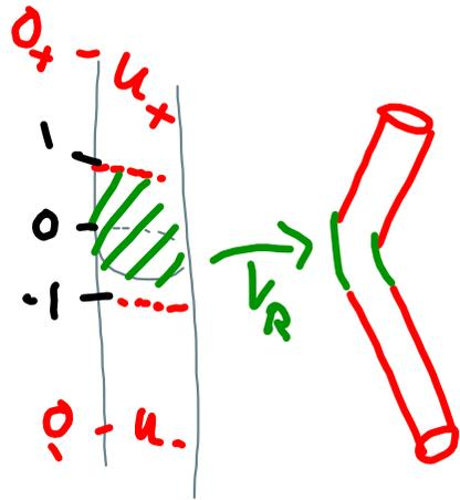
$$V_R(s, t) = \begin{cases} u_+(s - \frac{R}{2}, t) & ; s \geq 1 \\ h(s, t) u_-(s + \frac{R}{2}, t) \\ \quad + (1 - h(s, t)) u_+(s - \frac{R}{2}, t) & ; -1 < s < 1 \\ u_-(s + \frac{R}{2}, t) & ; s \leq -1 \end{cases}$$
